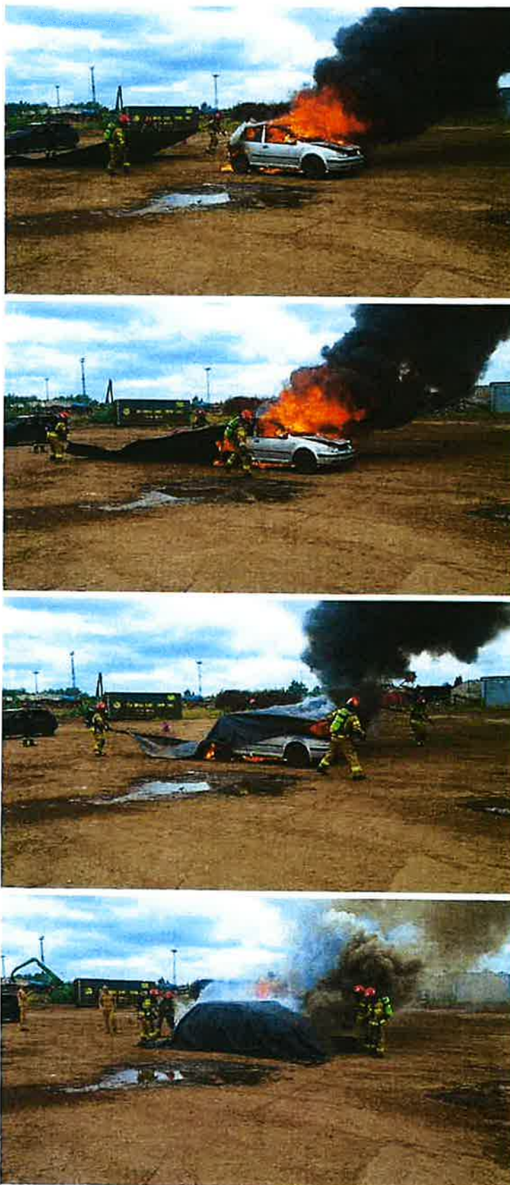
Fot. 26 – 29. Nakładanie płachty Bridgehill typu CAR PRO X na płonący pojazd Źródło: CNBOP-PIB.
