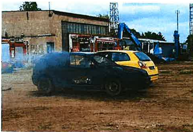
Fot. 20. Pojazd po zdjęciu płachty Bridgehill typu CAR PRO X Źródło: CNBOP-PIB.
