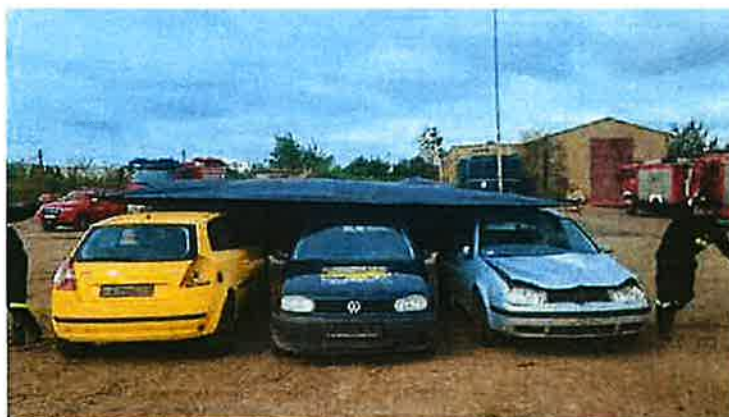
Fot. 6. Nakładanie płachty Bridgehill typu CAR PRO X przez 3 pojazdy na placu Centrozłom Źródło: JRG Oława.
