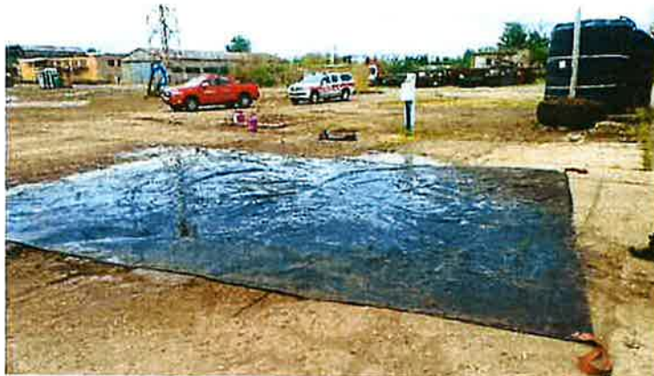
Fot. 21. Płachta Bridgehill typu CAR PRO X po jednym użyciu i przemyciu wodą Źródło: CNBOP-PIB.
